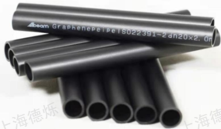
地暖管指低温热水地面辐射采暖系统（简称地暖）中，用来作为低温热水循环流动 PE-RT管材、管件是以聚乙烯-辛烯共聚物为主要原料。它所用原料具有独特的分子结构，它以线性乙烯为主链，加上可控分支，从而具有良好的耐水压性能。它的柔韧性特别好，在施工时容易弯曲而且不会变形，耐低温冲击性突出，安全卫生，热熔连接，接口可靠，永不渗漏，是地板采暖的理想管材。载体的一种管材。看地暖管材的外表，质量好的地暖管材外表比较光滑没有凹凸、气泡、明显的色差和杂质，而且地暖管材上都表明地暖管材的型号、规格和品牌。好的地暖管材上面的印字比较清晰而且不易脱落。管道易弯曲，弯曲后不易反弹，避免在使用过程中由于应力集中而引起管道在弯曲处出现破坏。新疆德硕地暖管维修电话
